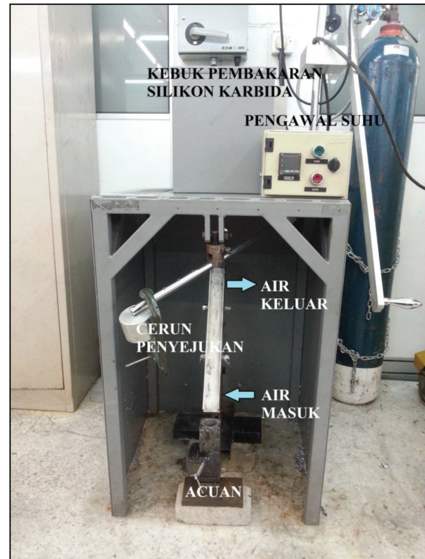
RAJAH 1. Alatan tuangan cerun penyejukan
